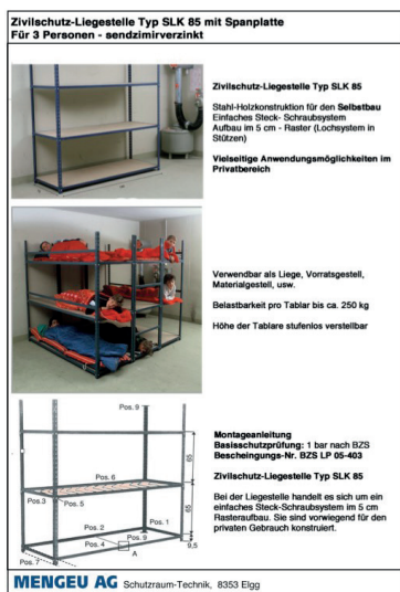
Merkblatt für eine Zivilschutz-Liegestelle in der Jetztzeit – auch im Privatbereich praktisch einsetzbar. Die Firma Meneu in Elgg bietet die gesamte Palette von Schutzraumtechnik an. (meneu.ch)
